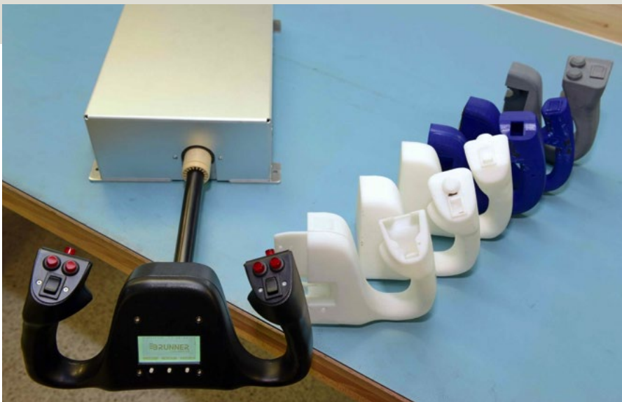
Разработка конструкции от первых набросков до готового штурвала оптимальной формы со встроенной электроникой. Проектирование было реализовано в системе Solid Edge, а опытные образцы изготавливались на 3D-принтере. (Фотограф: М. Фрутиг)
