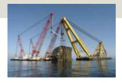
Аспекты операции по подъему судна «Остов лежащего на боку и потерявшего плавучесть судна был настолько ослаблен, что он не выдержал бы прилагаемых при подъеме усилий», – поясняет Лойшейлдер. Инженерам компании SMIT потребовалось спроектировать конструкцию, крепящуюся к корпусу судна для повышения его прочности. На каркас были установлены перемычки, чтобы заводимые тросы не разрушили ослабленный корпус судна в ходе подъема.
