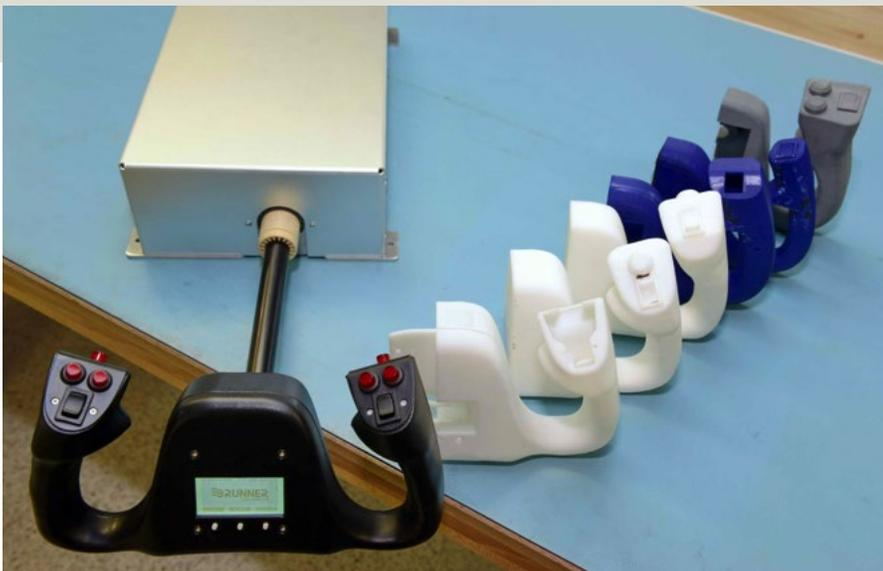
Разработка конструкции от первых набросков до готового штурвала оптимальной формы со встроенной электроникой. Проектирование было реализовано в системе Solid Edge, а опытные образцы изготавливались на 3D-принтере.
