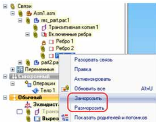
Рисунок 77. Заморозка/разморозка транзитивных связей в сборке
