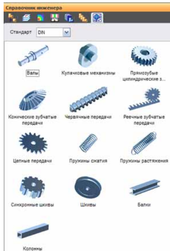
Рисунок 51. Инженерный справочник позволяет выполнять проектный и проверочный расчет механических передач
