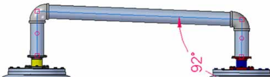
Рисунок 40. Solid Edge дает возможность смоделировать технологический уклон, используя стандартные фитинги
